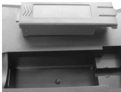
3. Установите модуль интерфейса. Сдвиньте модуль вперед до упора.
