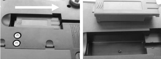
3. Installare il modulo di interfaccia. Far scorrere il coperchio in avanti per innestare i collegamenti.
