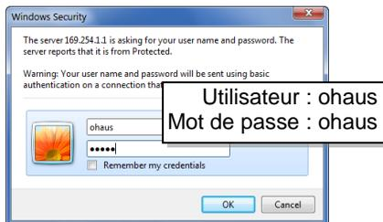
4. Cliquer « Network Configuration » [configuration réseau] sur le côté gauche et saisir l'utilisateur et le mot de passe. Ensuite, cliquer « OK » pour poursuivre.
